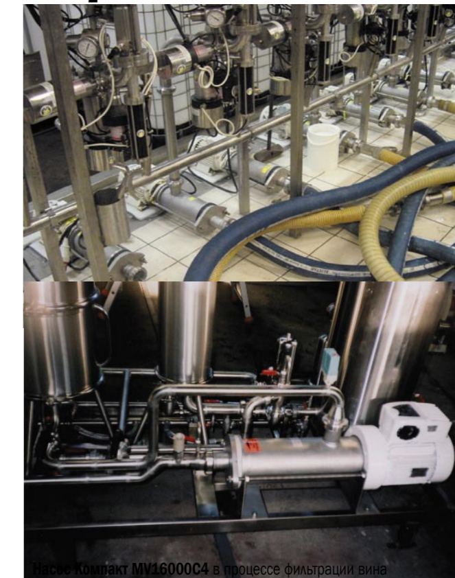
Насос Компакт MV16000C4 в процессе фильтрации вина
