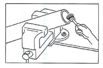
Для проведения монтажа очистите конец шланга с помощью щетки.
