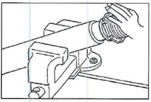
Нанесите смазку на внутреннюю поверхность шланга для облегчения вставки фитинга до его упора.
