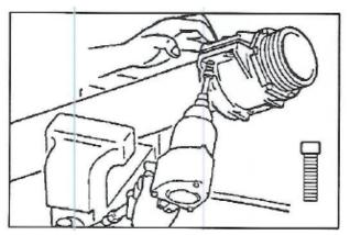
Расположив обжимную муфту в требуемом положении, можно затем последовательно заменить длинные винты на винты меньшей длины (более подходящего размера).
