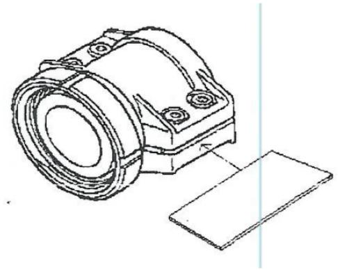
Затягивание винтов необходимо выполнять в порядке крест-накрест. На заключительном этапе необходимо использовать вкладыш (пластину) толщиной 1 мм для того, чтобы обеспечить равномерное зажатие обжимной муфты с обеих сторон.
