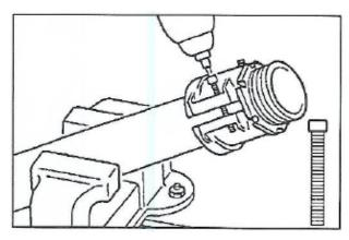
Установив фитинг в шланге, расположите полукольца обжимной муфты с обеих сторон шланга и закрепите их сначала с помощью длинных винтов.
