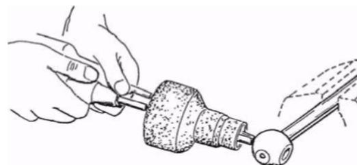
1) Возьмите две длинные отвертки без острых концов. Обильно смажьте конец приводной штанги и внутреннюю поверхность рукава.
