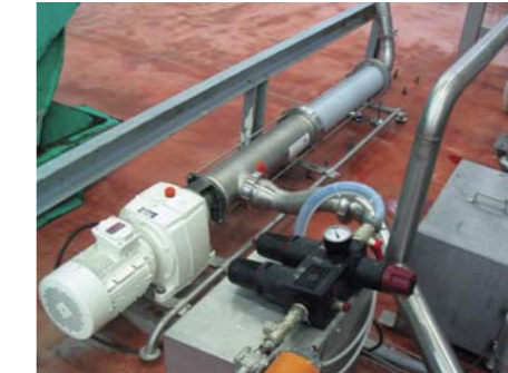
Насос Импакт 131A12 в процессе приготовления кормов для животных. Транспортировка и инъекция ингредиентов (масел, патоки, ферментов).
