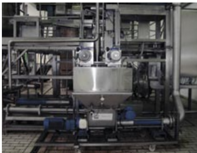
Насос GVB из нержавеющей стали в переработке фруктов, для перекачки яблочных выжимок
