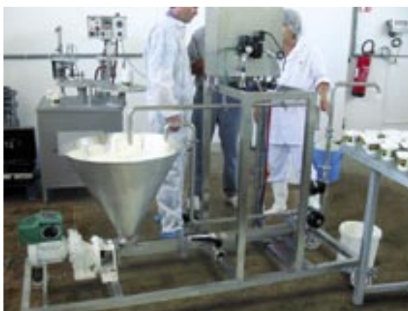
Пусковые испытания рамы приготовления и дозирования сыра в контейнеры.
