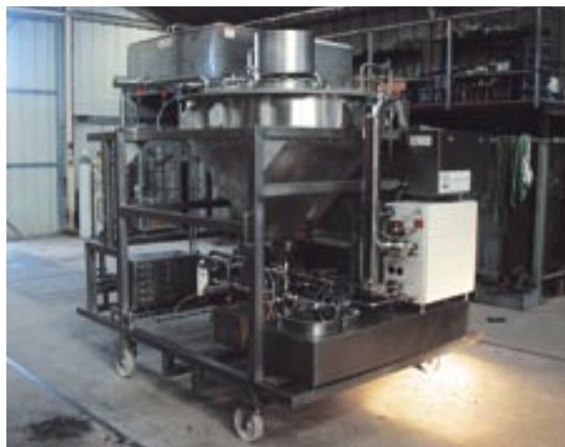
Система Viscofeeder® в производстве мороженого: дозирование и инъекция сверхвязких ингредиентов (карамель, шоколад, фруктовые наполнители...)
